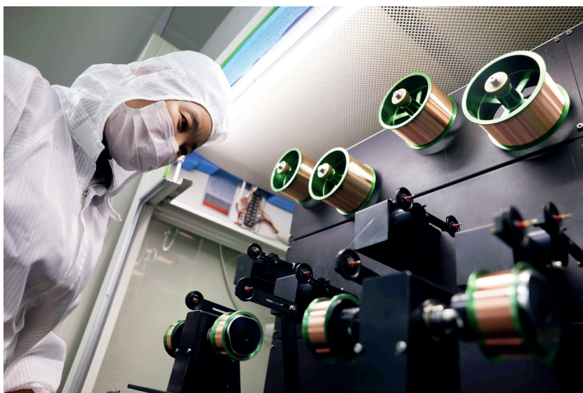
10月14日，安徽省合肥市瑶海区都市科技工业园，工人在键合丝生产车间内工作。键合丝是制造集成电路的重要材料。合肥着力扶持企业加大研发力度，助力芯片产业快速发展。 新华社发 解琛摄
