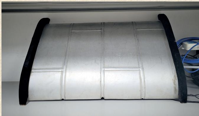
潘际銮团队制作的核反应堆铝池壳试验件（1960年代）
